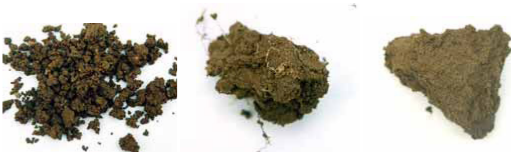
Figuur 2: Van links naar rechts: kruimels, afgerondblokkige en scherpblokkige elementen uit een kluit.
